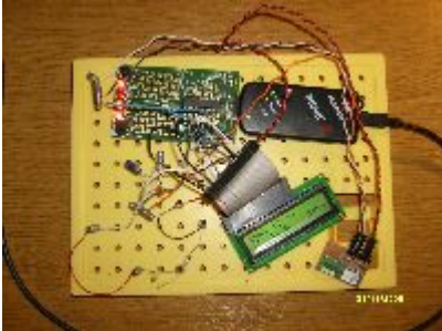
Slika 1: Prototip informacijskega zaslona. Zgoraj je viden programator PICKit 2, desno spodaj je GPS sprejemnik na bakreni ploščici.
