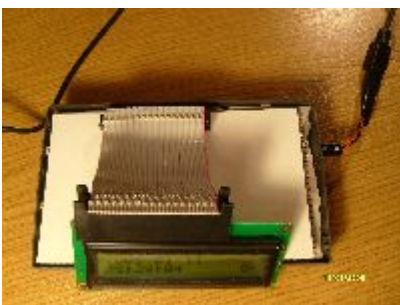
Slika 4: Informacijski zaslon tik preden sem prispajkal še LCD zaslon, Desno je viden pretvornik za USB kabel.
